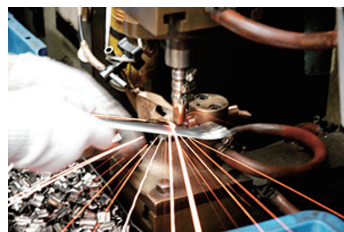
製造の一工程であるスポット溶接
